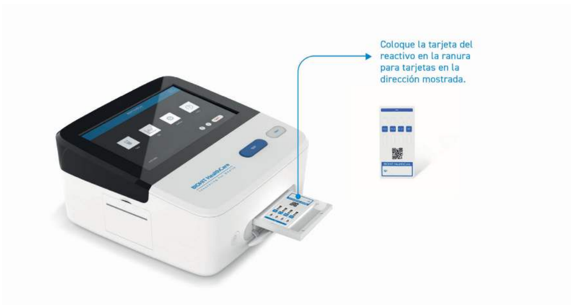
Figura 4.12. Inserción de la tarjeta de prueba de control de calidad en la bandeja del cartucho.
