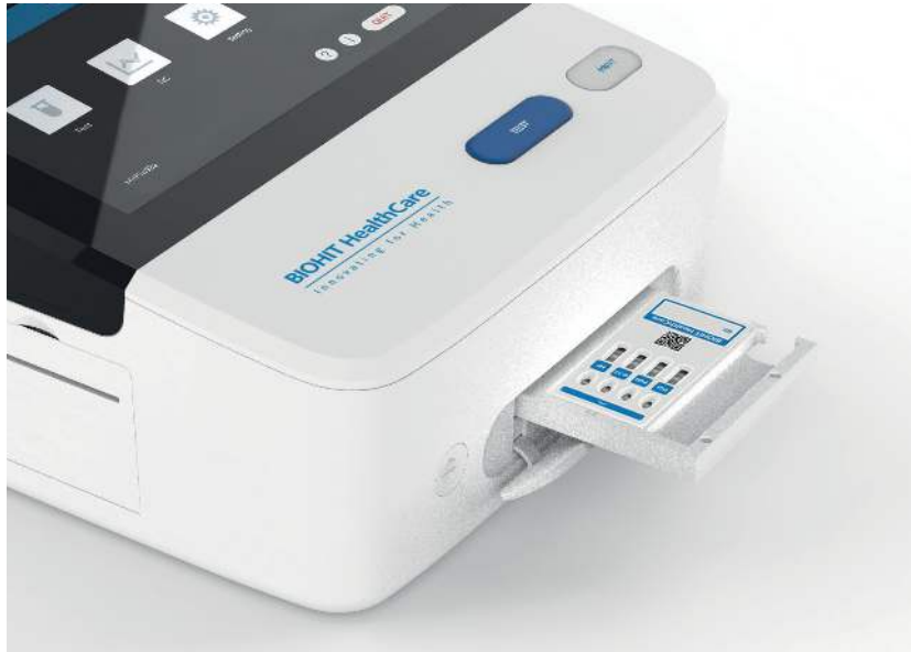
Figura 4.5. Imagen que muestra cómo se inserta el cartucho de prueba en la bandeja.
